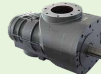
斯可络主机排气端使用了两对对面的重载锥形滚柱轴承，对径向和轴向的推力载荷产生了一个较大的安全系数，有效控制转子的窜动，大大延长主机的使用寿命。
