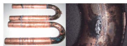
■ 没有镍处理后的铜管
